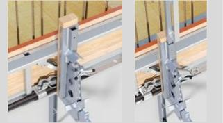
Der Steckpfosten muss mit dem Sicherungsbolzen des Steckpfosten im Sicherungsloch des Vierkantrohres einrasten.
