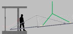
MS-Plattform 2000 muss ganz an der Betonkante angelegt werden, so dass der Kräfteverlauf, gemäss der berechneten Statik, nicht beeinträchtigt wird. Die Tragholme müssen im rechten Winkel zu der Betonkante montiert werden. Im Winter ist darauf zu achten, dass die Bereiche der Auflage der Tragholme von Schnee und Eis absolut frei sind.
