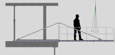
Werden Deckentische aus- und eingefahren, sind die Deckenstützen an der Deckenunterschicht ebenfalls mit einem DW-Anker Ø15 mm zu sichern.
