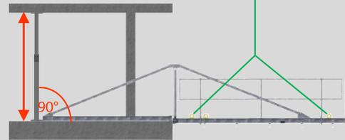
Sichern der Tragholme gegen Verschieben mit je einem DW-Anker Ø15 mm.
