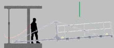
MS-Plattform Extrem 2000 muss ganz an der Betonkante angelegt werden, so dass der Kräfteverlauf, gemäss der berechneten Statik, nicht beeinträchtigt wird. Die Tragholme müssen im rechten Winkel zu der Betonkante montiert werden.
