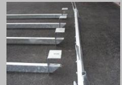
Einführen der Wangen in die Querholme. Die auf den Wangen aufgeschweissten Führungsnocken markieren und zentrieren die Position der Querholme.
