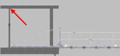
Die nötige Untersperrung vornehmen und die entsprechenden Sicherheitsmassnahmen gegen das unkontrollierte Wegrutschen treffen (Rücksprache mit dem örtlichen Bauingenieur).
