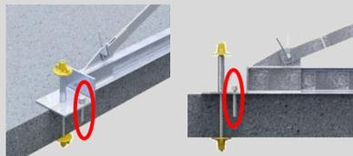
Die Deckenstützen dürfen oben nicht auf Träger oder Kanthölzer angelegt werden, sondern nur auf die Schalhaut oder direkt auf den Deckenbeton.
