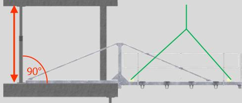
Sichern der Tragholme gegen verschieben mit je einem DW-Anker Ø15 mm.
