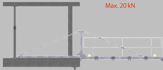
Zum Anheben der MS-Plattform Extrem 2000 sind die 4-Strang-Gehänge an den, speziell für das Anhängen vorgesehene und gelb markierten Aufhängepunkte, anzuschlagen.
