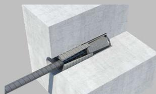
Der Felsanker darf nach dem Vorspannvorgang nicht aus dem Bohrloch hervorstehen.
