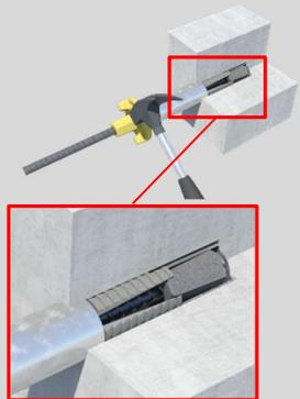
Die DW-Mutter und das Rohr wieder entfernen.
