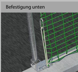
Den Zurrigurt in die Karabiner einschlaufen und den Zurrigurt anspannen bis in der Mitte der Feldlänge die Netzhöhe ab Standfläche von min. 1.50 m entsteht.
