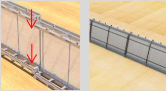
Bei Deckenstärken von 18 – 26 cm besitzt das Net-Form nur ein Quereisen. Beim Montieren des Net-Formes ist darauf zu achten, dass das Quereisen oben ist, um später die obere Armierung auf dem Quereisen aufzulegen.
