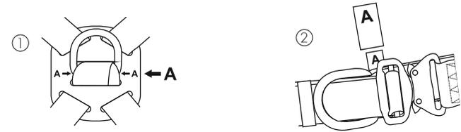
Vor jedem Einsatz der Absturzschutzausrüstung, zu welcher der Auffanggurt gehört, ist zu prüfen, ob alle Komponenten ordnungsgemäß verbunden sind und störungsfrei zusammenwirken, sowie ob sie den einschlägigen Normen entsprechen:
