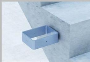
Kantholz 100 x 120 mm nach EN 338 mit Festigkeitsklasse C24 in den Treppengeländerhalter stecken und Keile vorne und seitlich einschlagen, bis das Kantholz sich nicht mehr verschieben kann.
