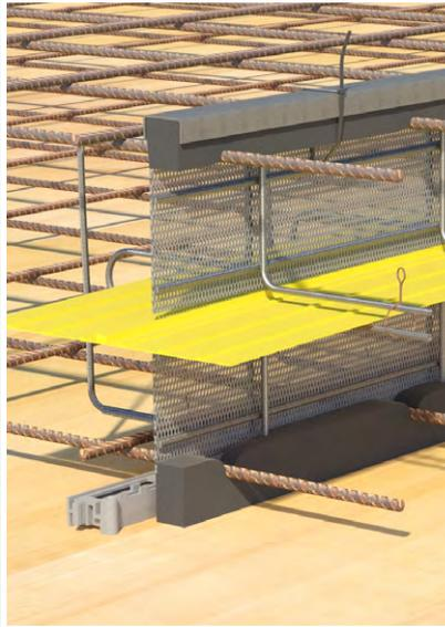
Dritte und vierte Armierung auflegen. Zum Abschalen der verbleibenden Betonüberdeckung eignet sich der Schalflex Abschalgummi Art. 1890...
