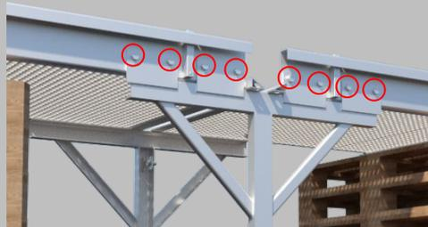
Querkreuz in jeder Ecke mit 6kt-Schrauben M16 x 35 an Seitenwangen befestigen.
